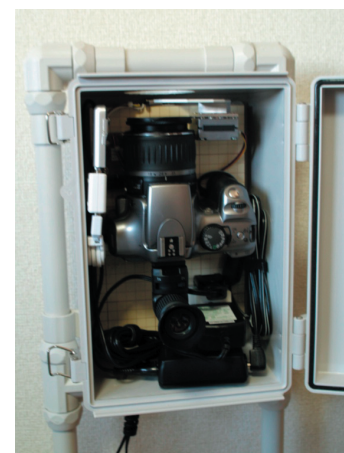
図6：連続観測用カメラボックス
