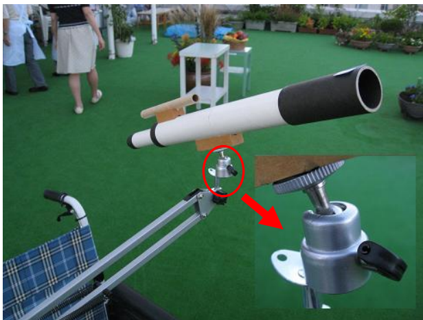
図 2 アーム先端に望遠鏡を取り付ける
