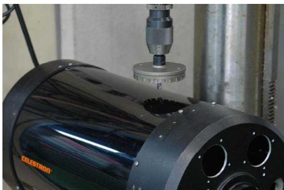
[鏡筒にφ12cmファン用穴を開けています]
