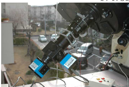
〔フリップミラーで2台のカメラを切替〕
