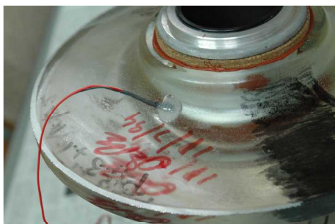
[温度センサーを主鏡に取り付け]
