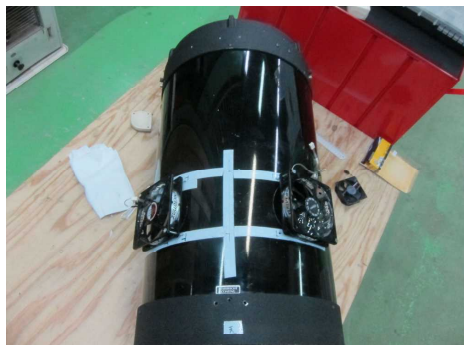
図3、[φ12cmファン2個を吸気用として設置]
