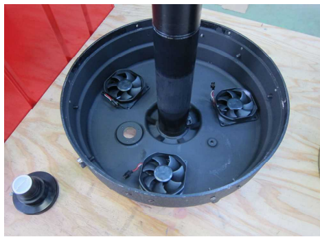
図4、[φ8cmファン3個を排気用として設置]
